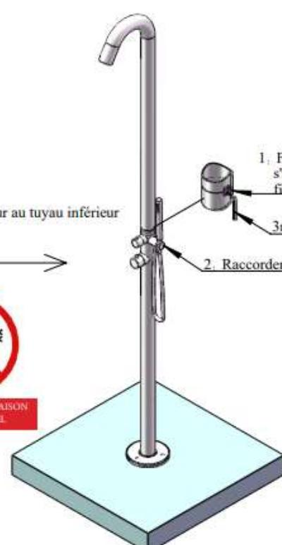
1. Faire coïncider la ligne arrière avec les deux tuyaux, s'assurer qu'il s'agit d'un rectangle, et bloquer la vis de fixation
