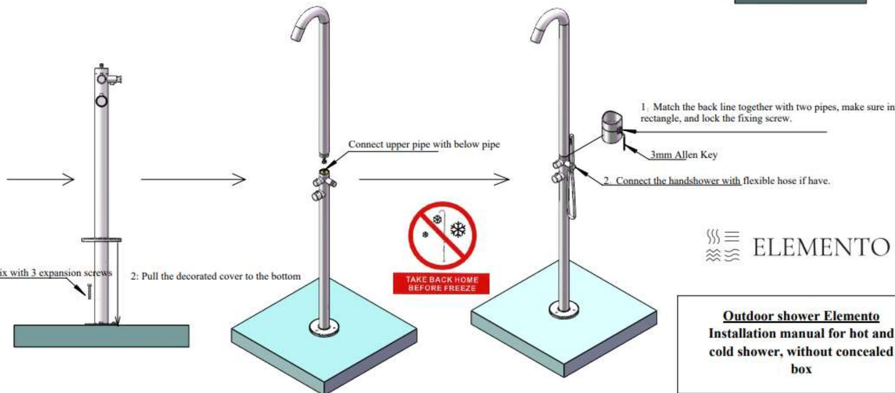
2 Stück 1/2"-Gewinde mit Wasserzulaufrohren verbinden, 15 mm über dem Boden
