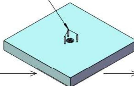
Die geflochtenen Rohre mit den verdeckten Wasserzulaufrohren verbinden und sicherstellen, dass sie nicht undicht sind.
