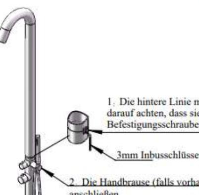
1. Die hintere Linie mit zwei Rohren zusammenfügen, darauf achten, dass sie ein Rechteck bilden, und die Befestigungsschraube festziehen.
