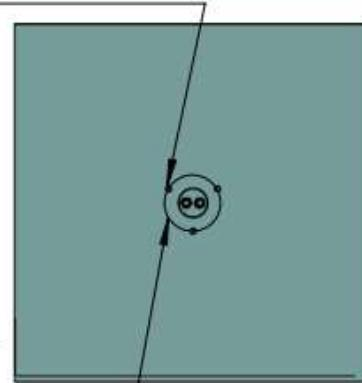
3 Spreizhülsen in die 3 Löcher einsetzen
