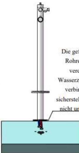
3 Löcher gleichmäßig auf einem Kreis mit einem Durchmesser von 126 mm bohren
