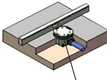
Vergewissern Sie sich, dass die Montagebox eben und ausgerichtet ist. Montagebox mit 4 x MS-Schrauben an der Bohrung befestigen, dabei darauf achten, dass die Bodenfliesen höher als die untere Linie und niedriger als die Mittellinie der Montagebox liegen.
